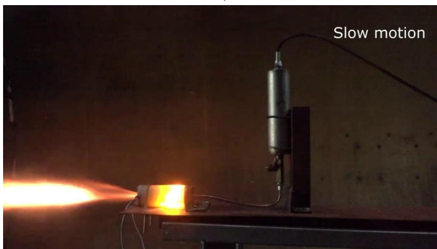
Рисунок 3 – Схема механічної частини стенду: а) вид збоку; б) вид спереду; в) стенд під час випробувань РДТП; г) стенд під час випробувань РРД
