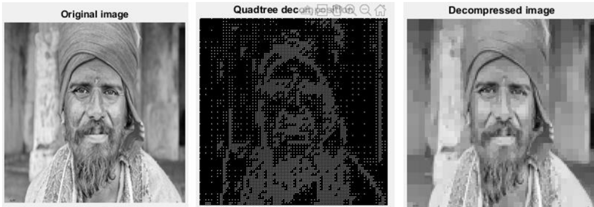
Рисунок 1 – Результат роботи програми стиснення зображення: вхідне зображення (ліворуч), розкладання за допомогою квадродерева (по центру), відновлене зображення (праворуч)
