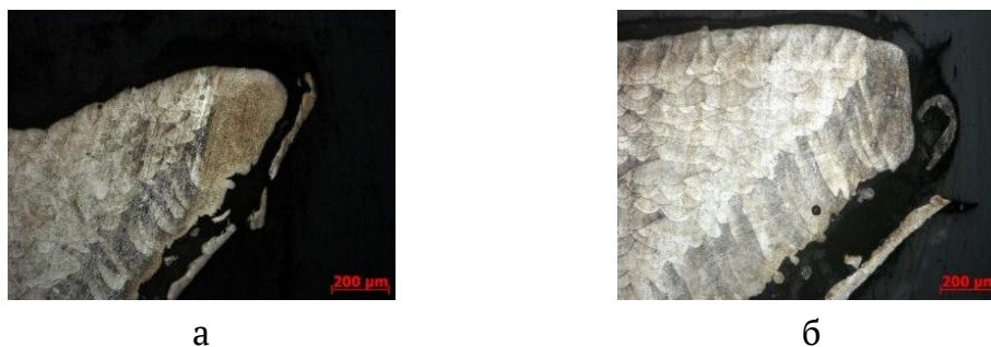
Рисунок 5 – Дослідження мікроструктури в області тонкого краю: а – прямолінійна стратегія заливки шару, б – заливка шару у шаховому порядку [9]
