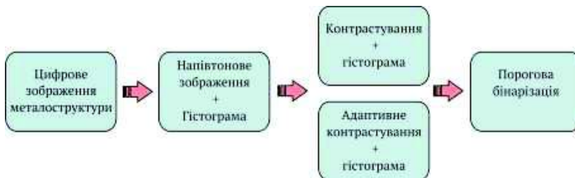
Рисунок 3 – Послідовність цифрової обробки зображень металоструктур з кірбідними вкрапленнями
