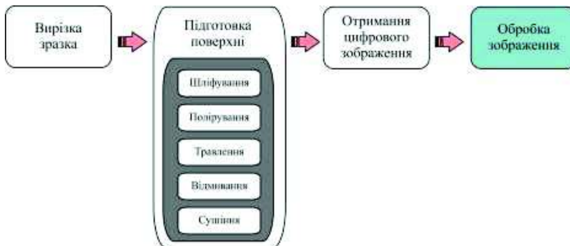
Рисунок 1 – Послідовність операцій при вивченні структури металу
