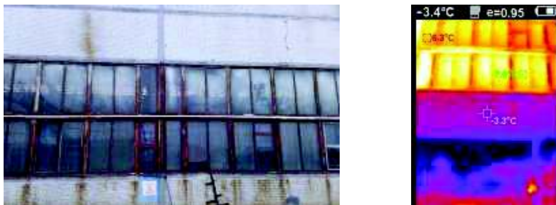
Рисунок 3 – Термографічна зйомка скління конструкції
