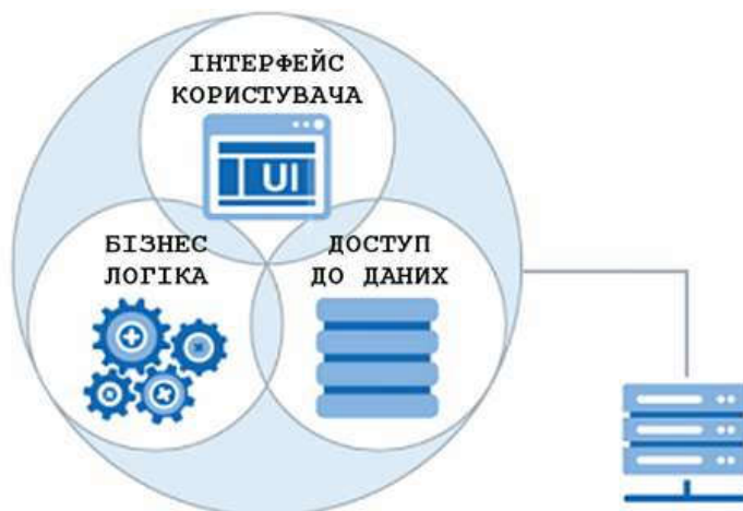
Рисунок 1 – Схема архітектури монолітного додатку
