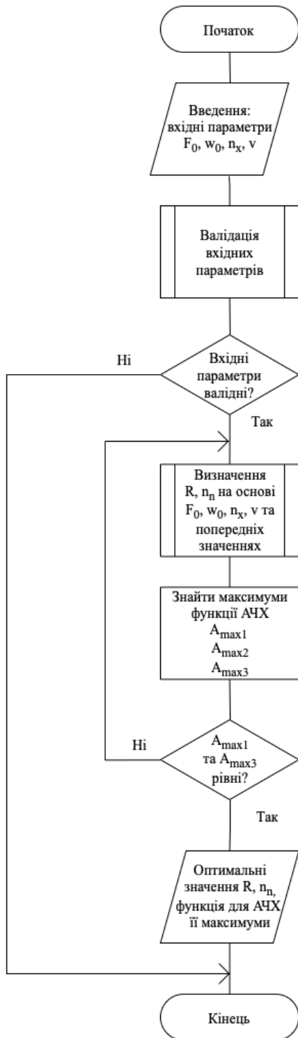
Рисунок 2 - Блок-схема методу побудови цифрового двійника віброзахисної системи з оптимальними параметрами
