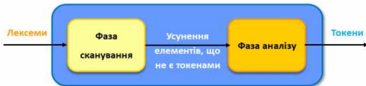
Рисунок 2 – Функціональний склад лексичного аналізатора
