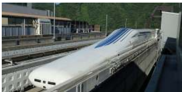
а) носовий обтічник та секції лінійного двигуна в бокових стінках шляхопроводу
