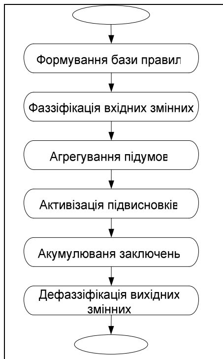
Рисунок 2 - Алгоритмічна схема нечіткого висновку
