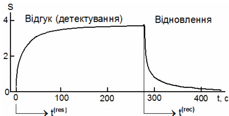
Рисунок 1 - Типова експериментальна кінетична залежність відгуку зразка резистивного газового сенсора ( t^{(res)} і t^{(rec)} осі часу, відповідні процесам детектування і відновлення)
