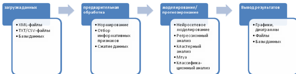
Рисунок 3 - Схема потока данных программного комплекса MiningLibs
