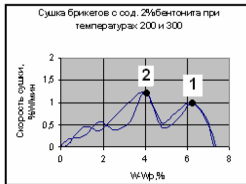
Рисунок 1 - Криві швидкості сушки брикетів при температурах 200 °C і 300 °C із вмістом бентоніту : 1)- 0,5% ; 2) - 2%
