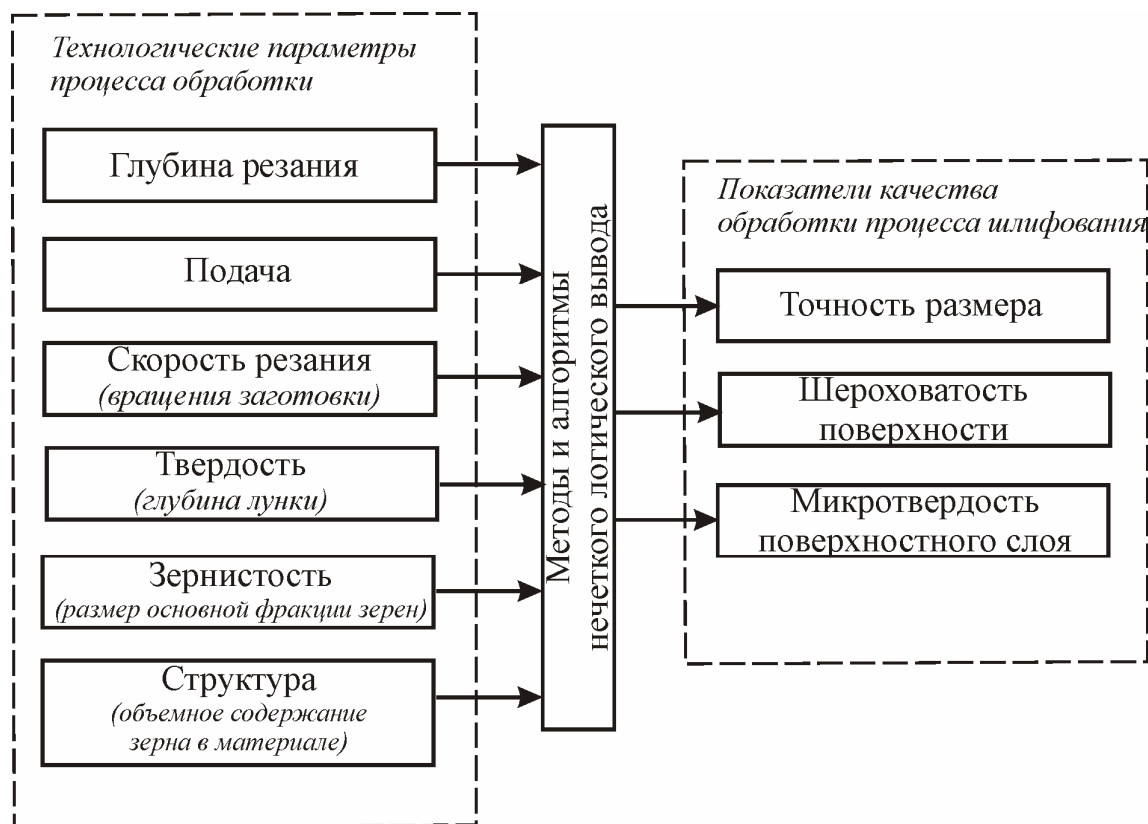
Рисунок 1 - Механизм ввода- вывода процесса внешнего цилиндрического шлифования деталей гидромашин
