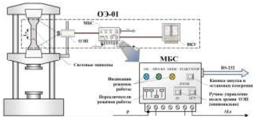
Рисунок 1 - Структурная схема оптоэкстензометра ОЭ-01
