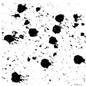
Рисунок 2 - Изображение коррозии поверхности нержавеющей стали AISI 304
