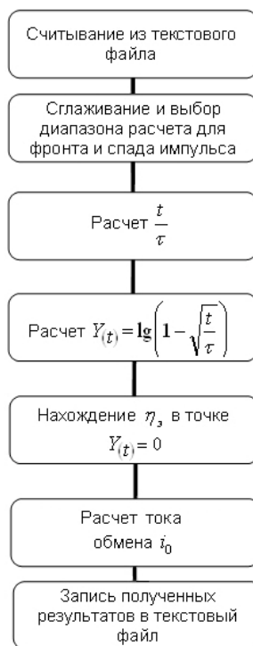
Рисунок 2 - Алгоритм расчета кинетических параметров электрохимического процесса в ХИТ
