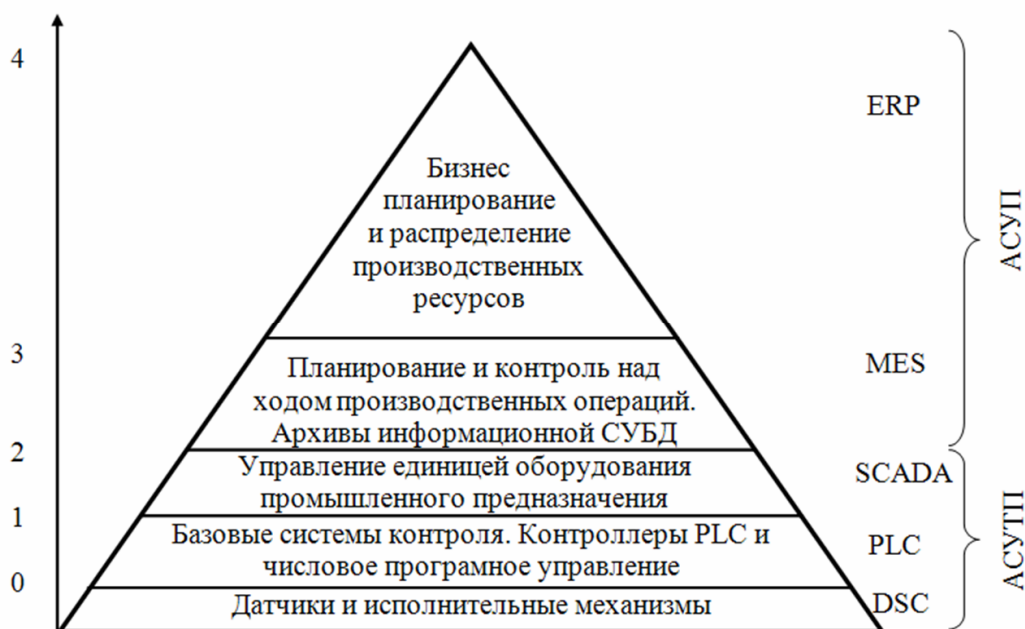
Рисунок 1 - Структура информационной сети машиностроительного комплекса по модели CIM
