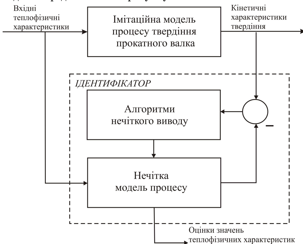
Рисунок 1 - Схема адаптивної ідентифікації по паралельній моделі
