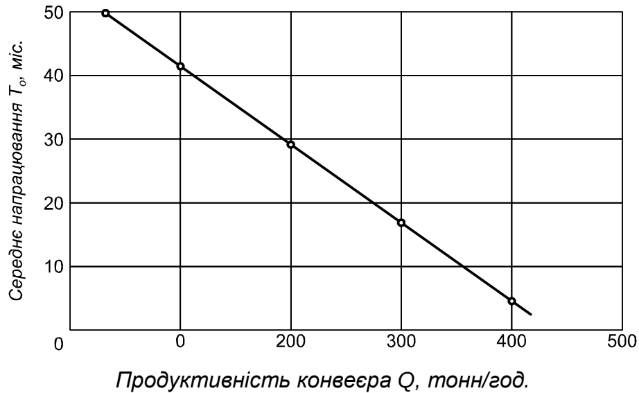
Рисунок 4 – Залежність середнього напрацювання стрічки до відмови T_0 від продуктивності конвеєра Q
