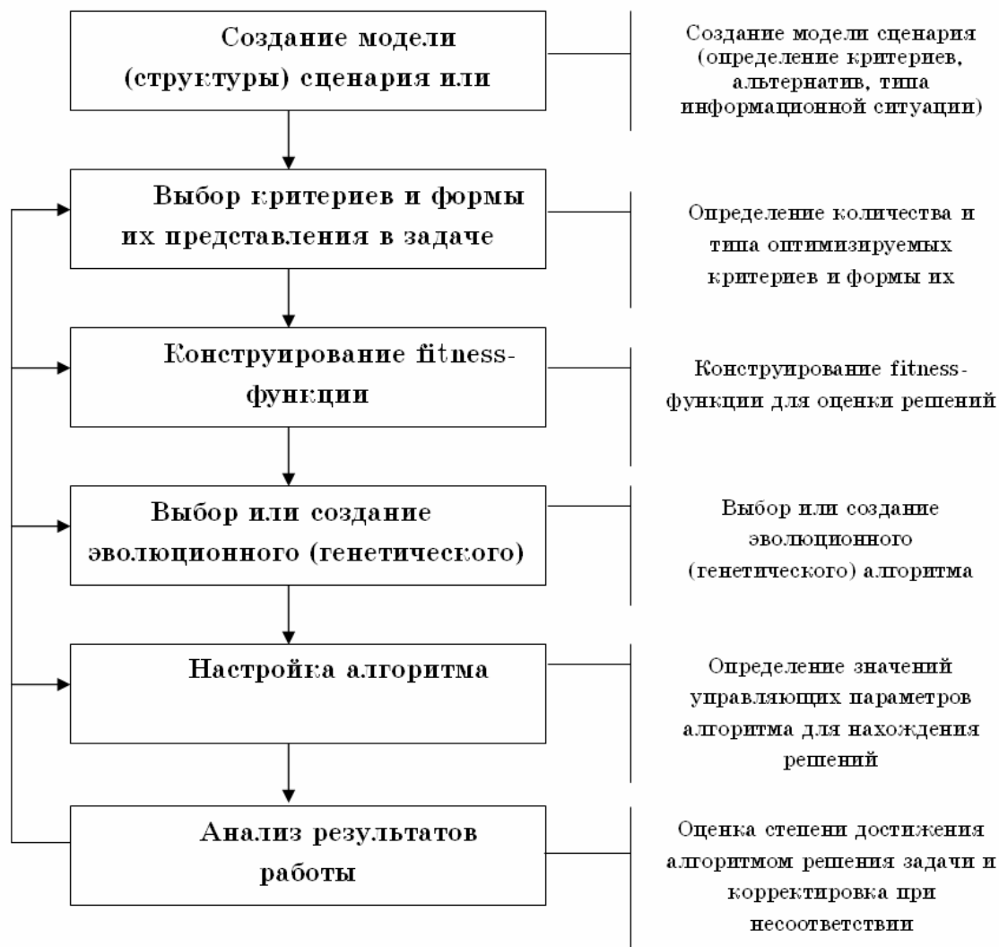
Рис. 2. Общая схема применения эволюционных алгоритмов в задачах сценарного планирования
