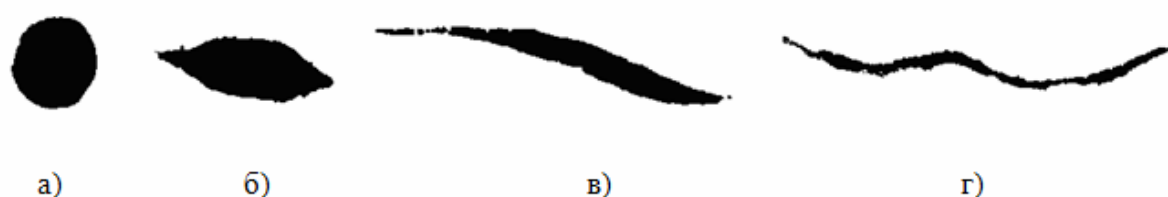
Рисунок 1 - Сталь 08Ю. Изменение формы пластичного сульфида при деформации стали 08Ю со степенью деформации \varepsilon : а) \varepsilon = 10\% ; б) \varepsilon = 20\% ; в) \varepsilon = 35\% ; г) \varepsilon = 60\%
