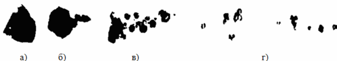
Рисунок 1 - Сталь 08Ю. Изменение формы пластичного сульфида при деформации стали 08Ю со степенью деформации \varepsilon : а) \varepsilon = 10\% ; б) \varepsilon = 20\% ; в) \varepsilon = 35\% ; г) \varepsilon = 60\%
