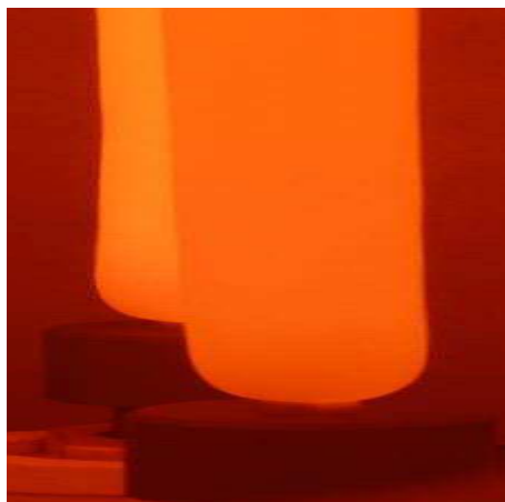
Рисунок 5 - Визуальное наблюдение разогретых стержней ПКК в Реакторе
