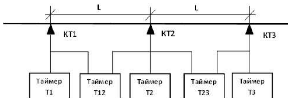
Рисунок 1 – Структурная схема участка определения межосевых расстояний
