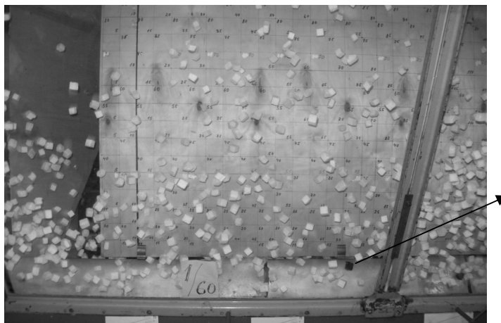
Рисунок 3 – Перемещение черного кубика (1) в фонтанирующем слое
