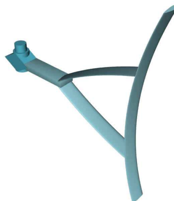
Рисунок 2 – Схема узла лопасть-траверсы
