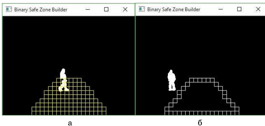
Рисунок 5 – Определение зоны интереса (а) и разбиение ее на отдельные области (б)
