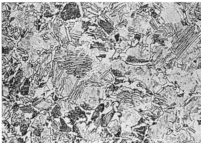
Рисунок 1 - Мікроструктура (x400) сталі 09Г2 прямокутної труби в гарячекатаному стані поставки
