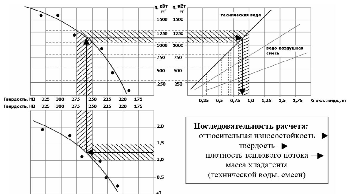
Рисунок 2 - Диаграмма режимов охлаждения отливки в зависимости от параметров износостойкости гильзы цилиндра двигателя
