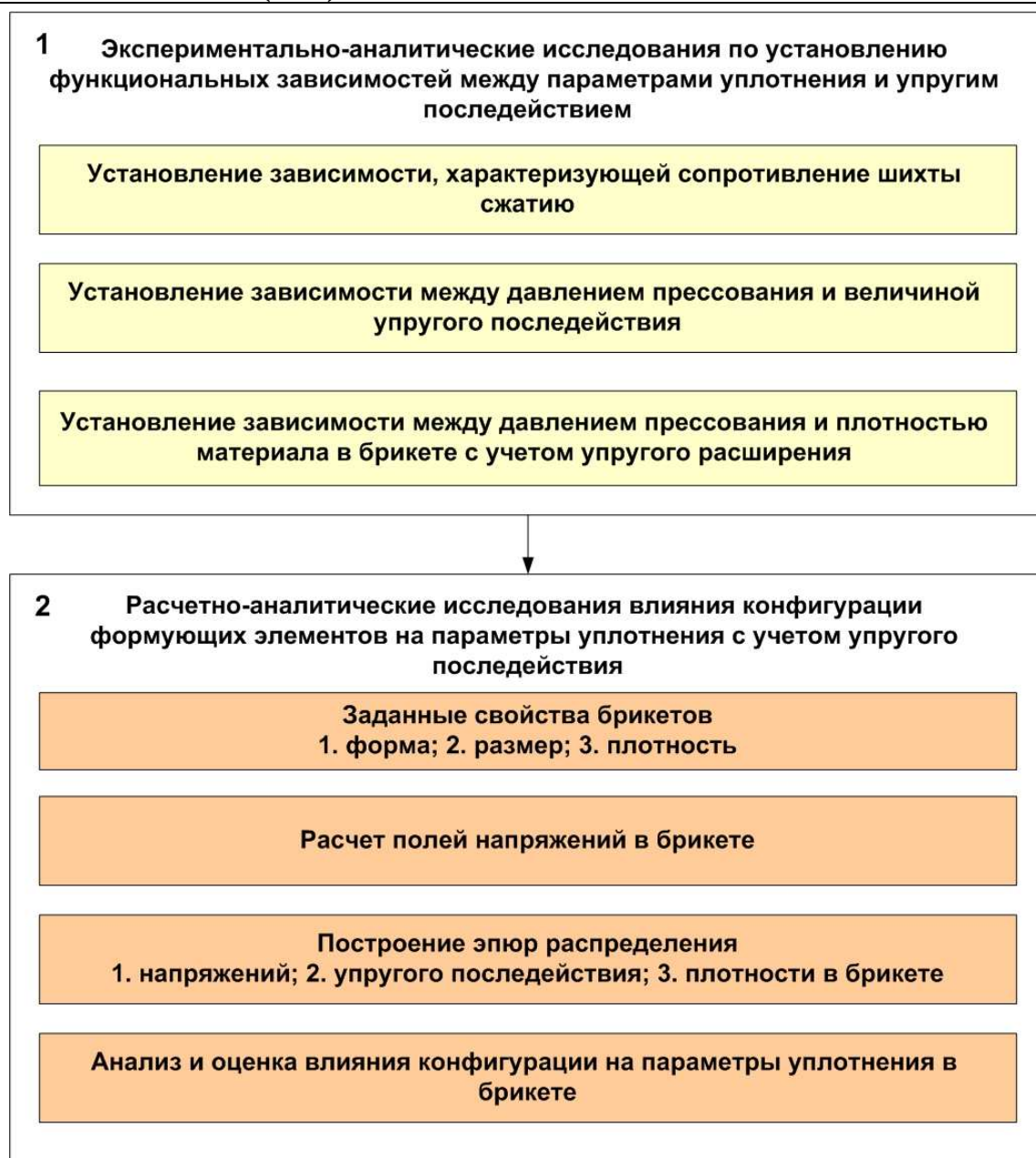
Рисунок 1 – Структура метода оценки влияния конфигурации формирующих элементов на упругое последствие в брикетах
