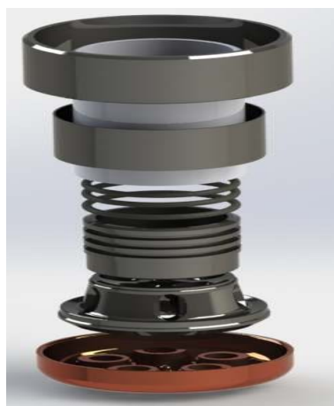
Рисунок 1 - Составляющие наконечника кислородно-конвертерной фурмы
