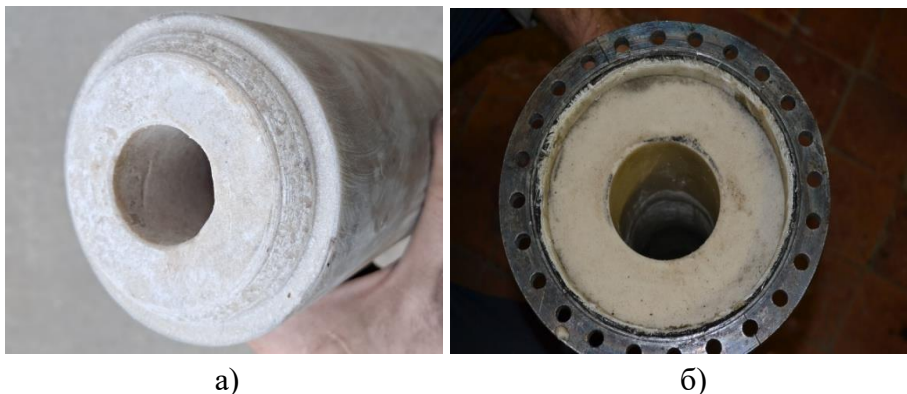
Рисунок 3 – Вкладний заряд і скріплений з корпусом
