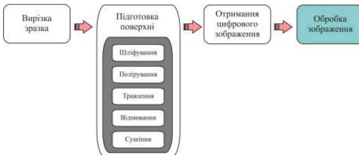
Рисунок 1 – Послідовність операцій при вивченні структури металу
