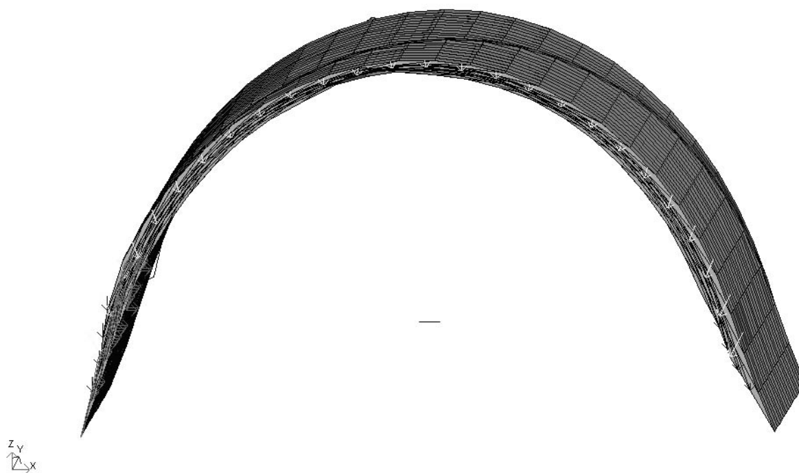
Рисунок 3 - Деформированная схема зубчатого соединения на приводном барабане
