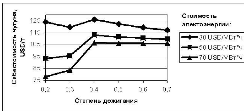
Рисунок 2 - Зависимость себестоимости чугуна от степени дожига газа в рабочем пространстве агрегата ПЖВ при разных ценах на электроэнергию
