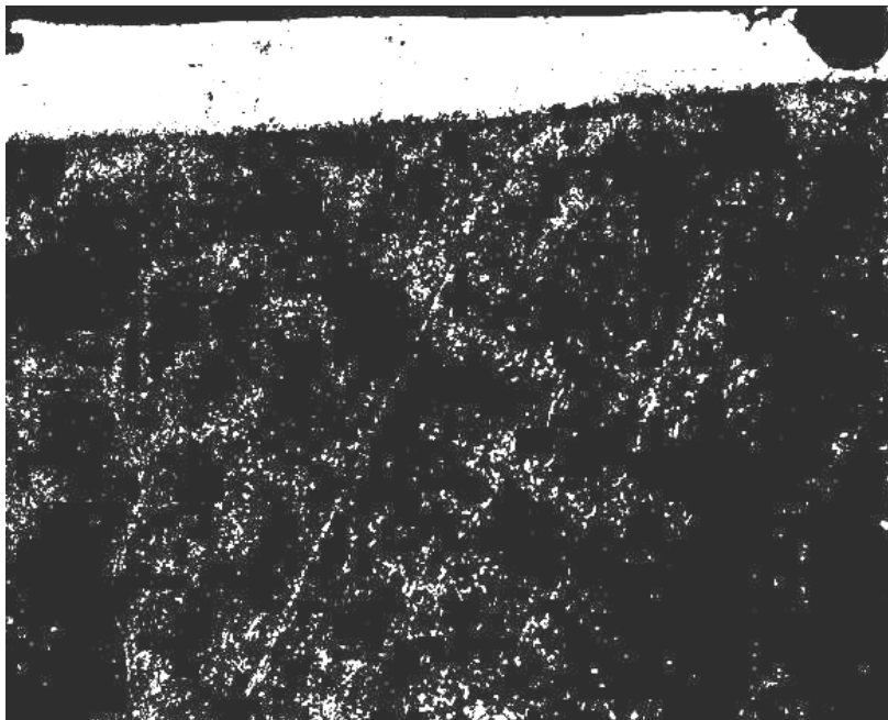
Рисунок 1- Микроструктура образца К1(шатунная шейка) после лазерной обработки, (Ч 200)
