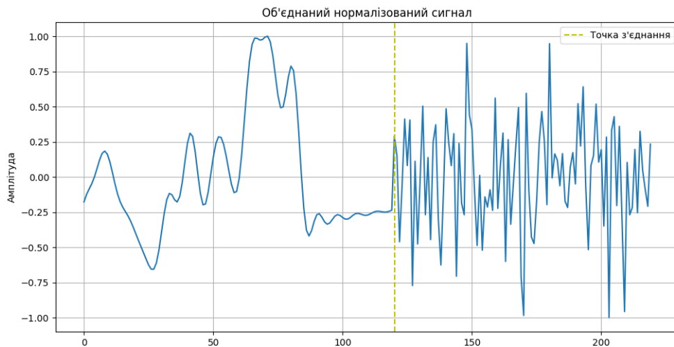
Рисунок 10 – Використання гаусівського шуму з синусоїдним доданком для прогнозування даних
