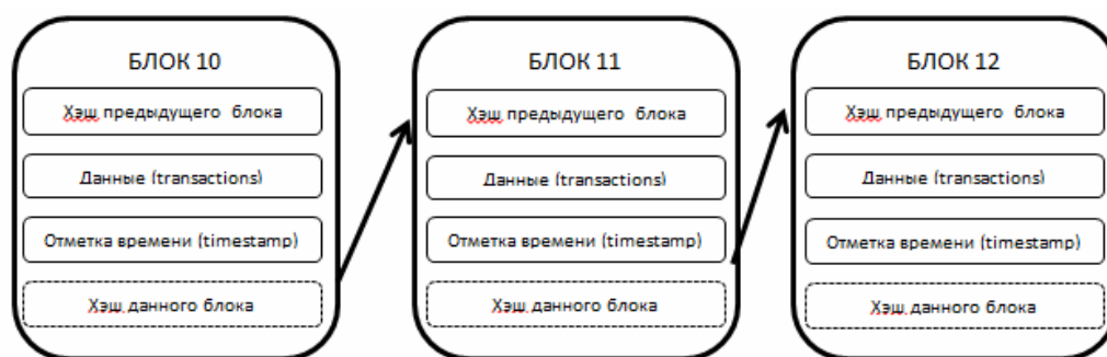
Рисунок 1 - Структура блока и построение блокчейна
