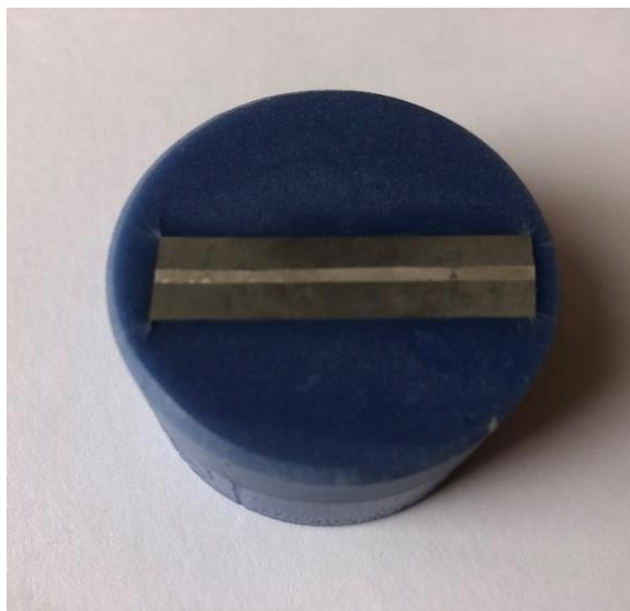
Рисунок 2 –Зразок, підготовлений для дослідження на мікроскопі
