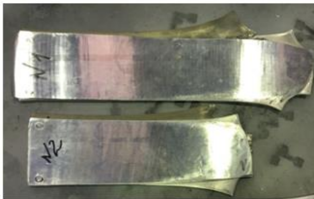
Рисунок 1 – Заготовки-пакети до (а) та після (б) прокатки
