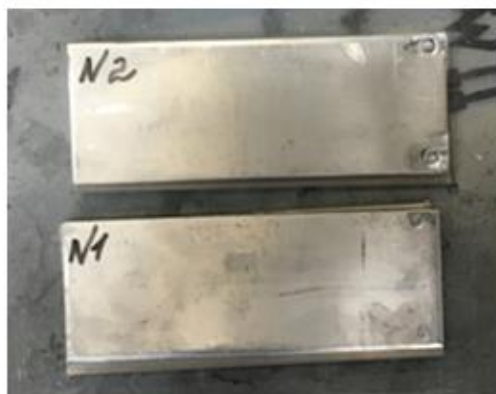
Рисунок 1 – Заготовки-пакети до (а) та після (б) прокатки
