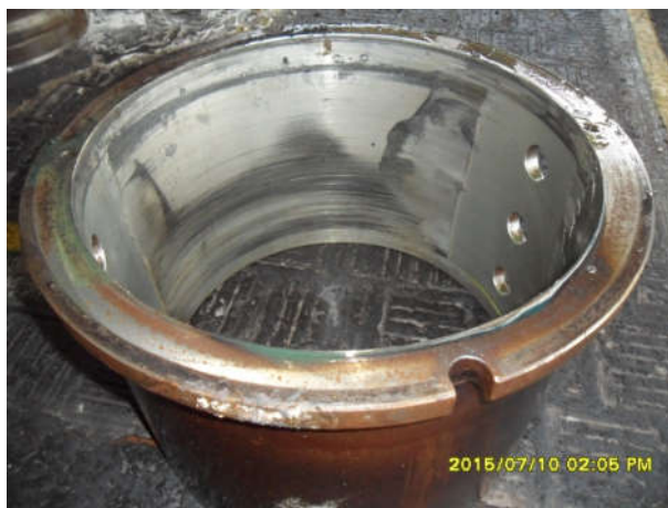
Рисунок 3 – Фотографії зносу поверхонь втулки та вкладиша ПРТ кліті 630
