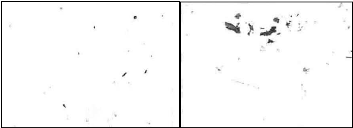
Рисунок 3 - Структура рабочего слоя исходного валка (а) и легированного азотом (б), x100
