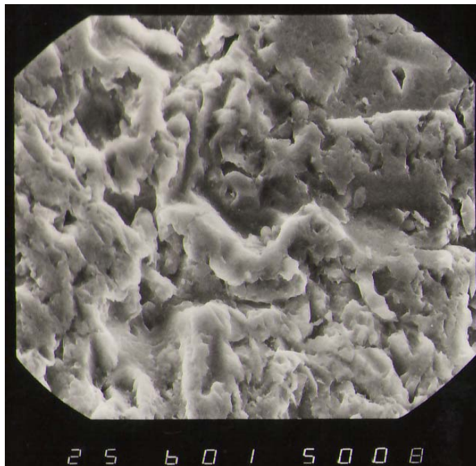
Рисунок 3 – Окончательный микрорельеф под действием искровых разрядов
