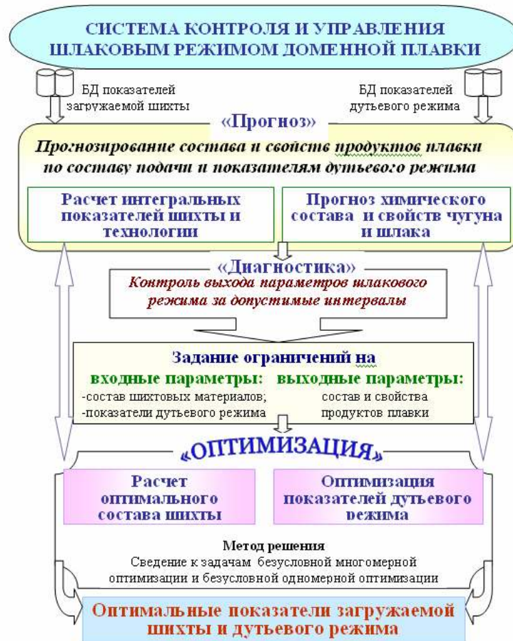
Рисунок 1 – Структурная схема автоматизированной системы «Шлак»
