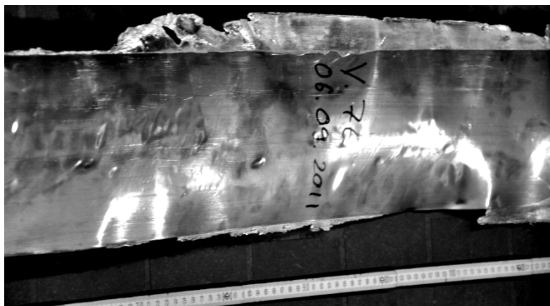
Рисунок – 7. Биметаллическая алюминиево-стальная полоса после принятия комплекса мер по ее стабилизации
