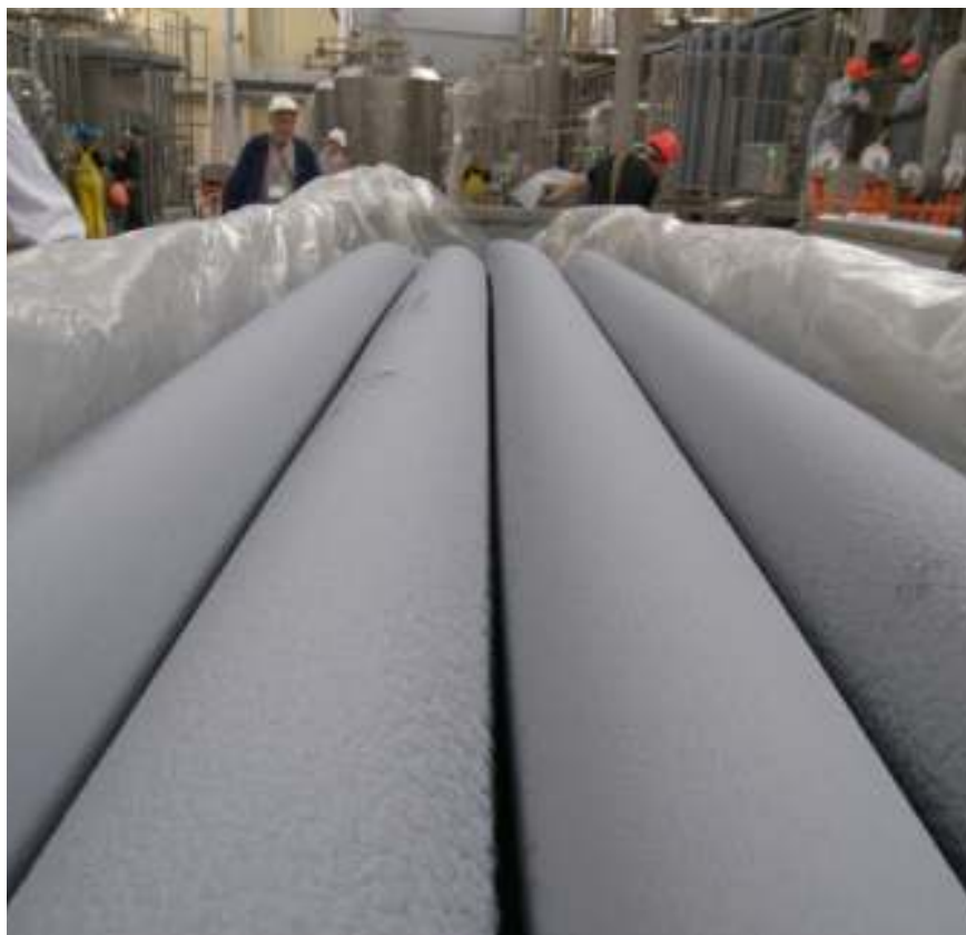
Рисунок 3. – Стержни ПКК после демонтажа из Реактора
