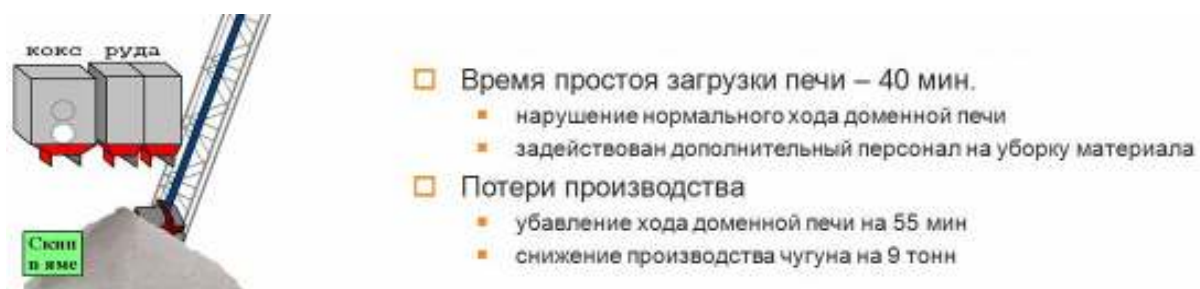
Рисунок 3. – Последствия исключения проверки заданного материала
