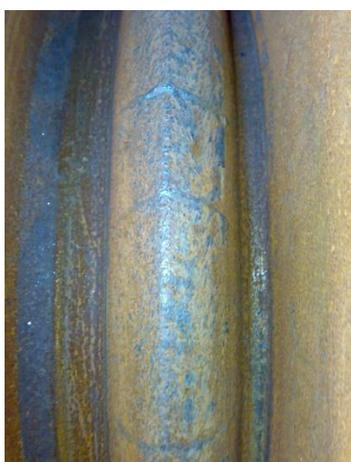
Рисунок 1 – Сетка разгара на поверхности валка рельсобалочного стана 800 ПАО «ЕВРАЗ-ДМЗ им. Петровского»
