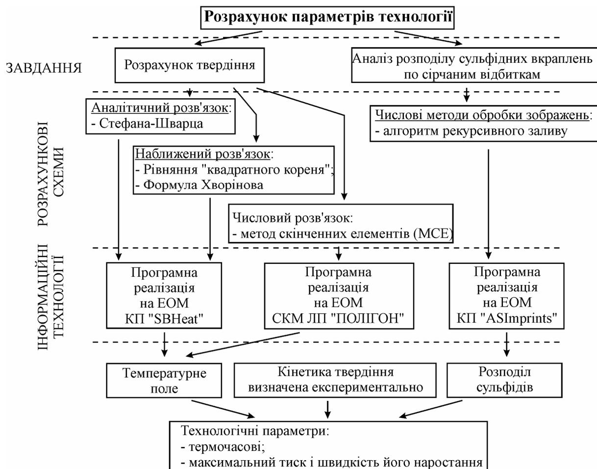
Рисунок 1 – Схема, що ілюструє загальну методику визначення технологічних параметрів на прикладі сталевго виливка
