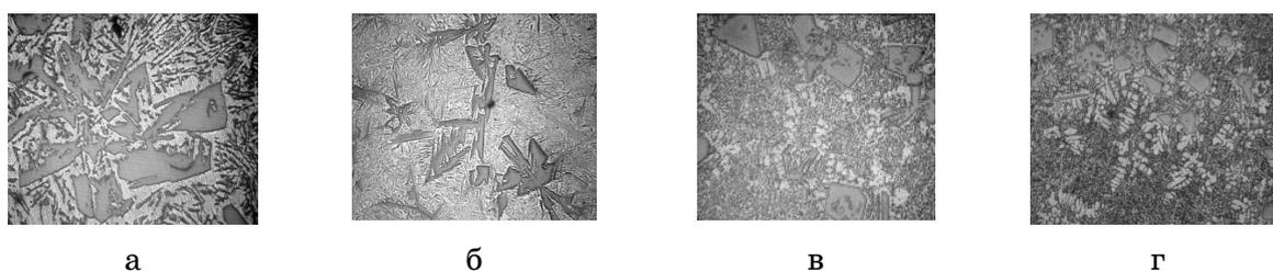
Рисунок 1 – Микроструктура сплава АК18(B-Sn) в исходном состоянии (а) и после обработок (б-в) по режимам, представленным в табл. 2:
