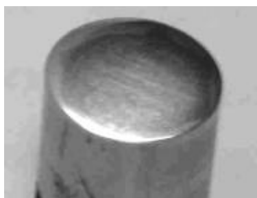
Рисунок 3 – Общий вид поперечного сечения многослойного проката быстрорежущей стали Р6М5 диаметром 14 мм (4х)
