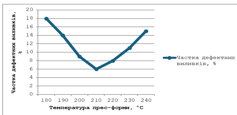
Рисунок 2 – Залежність дефектності лиття від температури прес-форми у фазі тверднення
