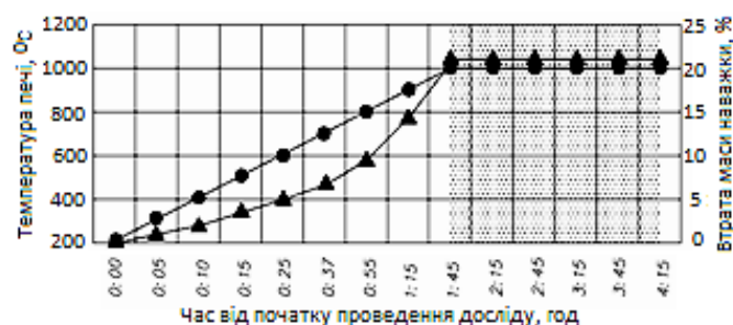
Рисунок 2 - Зміна втрати маси проби залежно від тривалості дослідів та температури в печі: закреслена область - витримка композиту протягом 150 хвилин при температурі 1000^\circ\text{C} ; ● - зміна температури в печі; ▲ - втрата маси наважки.
