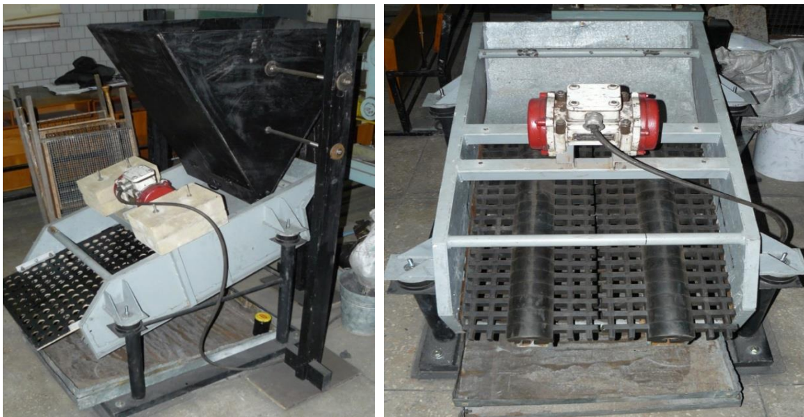
Рисунок 2 – Загальний вид лабораторної установки із встановленим в коробі плоско-листовим металевим ситом
