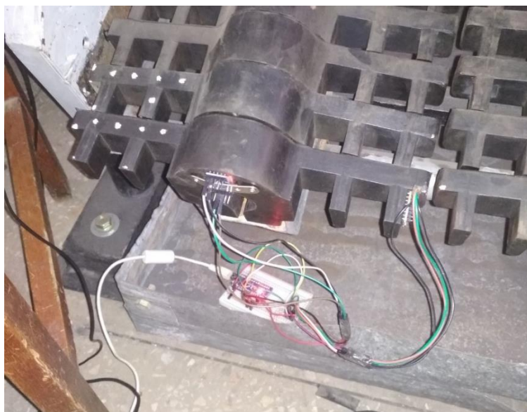
Рисунок 3 – Установка датчиков на эластичном картковом элементе просеивающей поверхности на вибрационном грохоте
