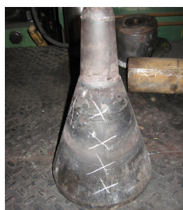
Рисунок 1 – Экспандер а), картины износа экспандера б), и втулки контейнера в) прошивного пресса 12 МН фирмы SMS MEER: 1 – игла; 2 – экспандер
