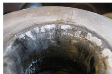
Рисунок 1 – Экспандер а), картины износа экспандера б), и втулки контейнера в) прошивного пресса 12 МН фирмы SMS MEER: 1 – игла; 2 – экспандер
