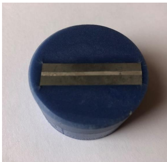
Рисунок 2 –Зразок, підготовлений для дослідження на мікроскопі
