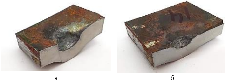
Рисунок 3 – Зовнішній вигляд зразків після балістичних випробувань, вібраційне навантаження 20 Гц: а – зразок з початком фрагментаційного руйнування, б – зразок з опуклістю
