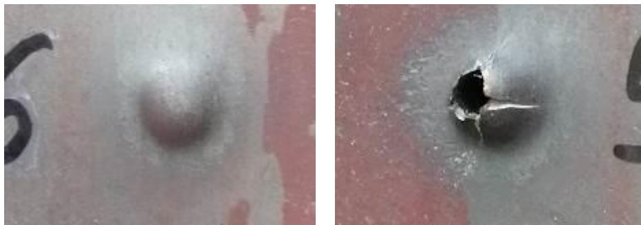
Рисунок 2 – Зразки пластини після балістичного випробування з вібраційним навантаженням 10 Гц: а – зразок, що витримав випробування, б – пластично-пелюсткова перфорація з додатковим розтріскуванням опуклої сторони
