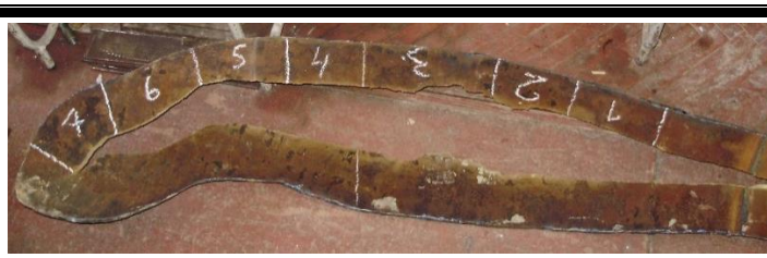
Рисунок 2 – Місце руйнування труби
