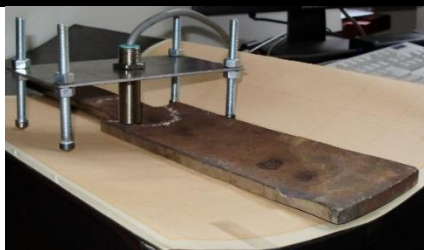
Рисунок 3 – Стенд для сканування дефектів на внутрішній поверхні зразка
